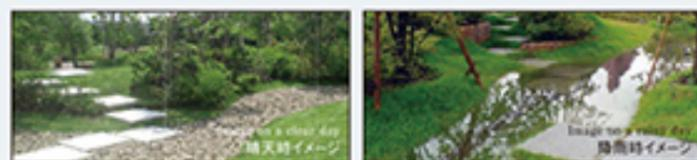
降雨時に雨水を一次貯留し、徐々に浸透させることで地下水を涵養。下水道負荷の軽減とともに、水質浄化を図るガーデンで、天候や季節によって量観が変化します。
